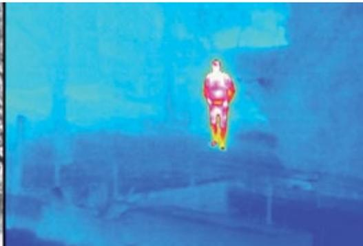
*Mit Wärmebildkameras wird das Unsichtbare sichtbar gemacht. Diese modernen Geräte stellen die Bilder im visuellen Spektrum dar, indem sie die Temperaturunterschiede zwischen einem Objekt und dessen Umgebung erkennen.*
